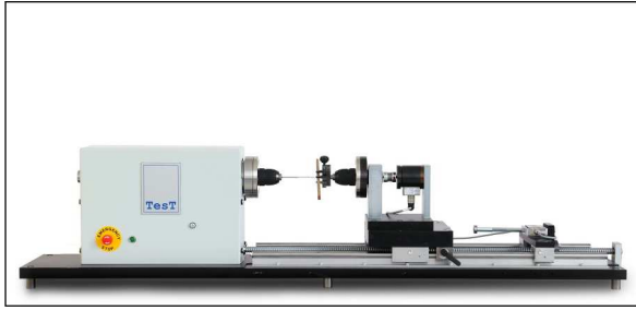
Kombinierte Prüfmaschine mit gleichzeitiger Axial- und Torsionsbelastung
