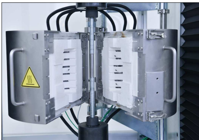
Temperierkammern und Öfen für die Material- und Bauteilprüfung unter Temperatureinfluss
