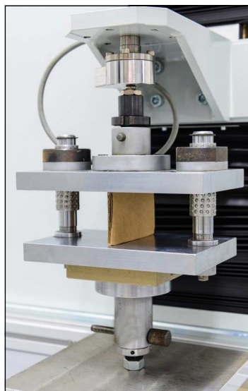
BCT Kartonprüfung (Verpackungsindustrie)
