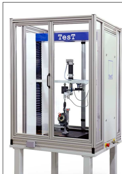
TesTcenter für Druck-, Zug- und Torsionsprüfung
