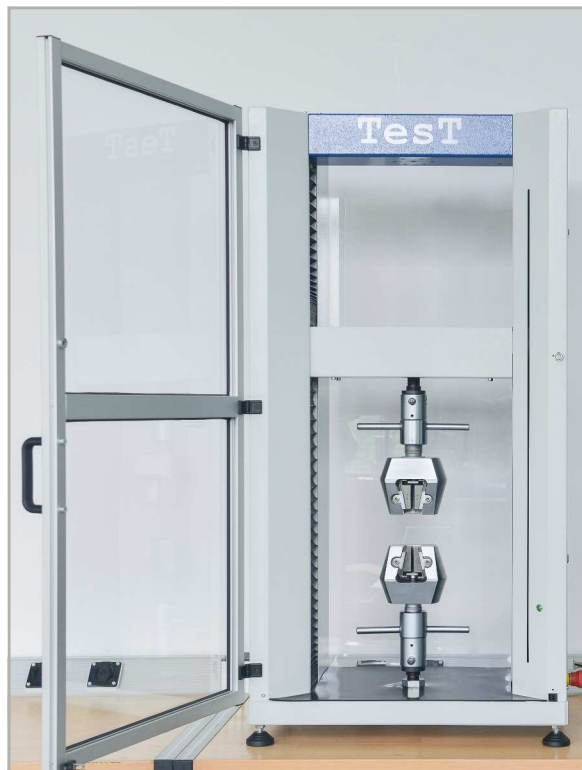
Universalprüfmaschine 112.50kN mit Keilspannzugwerkzeug für Zugversuche
