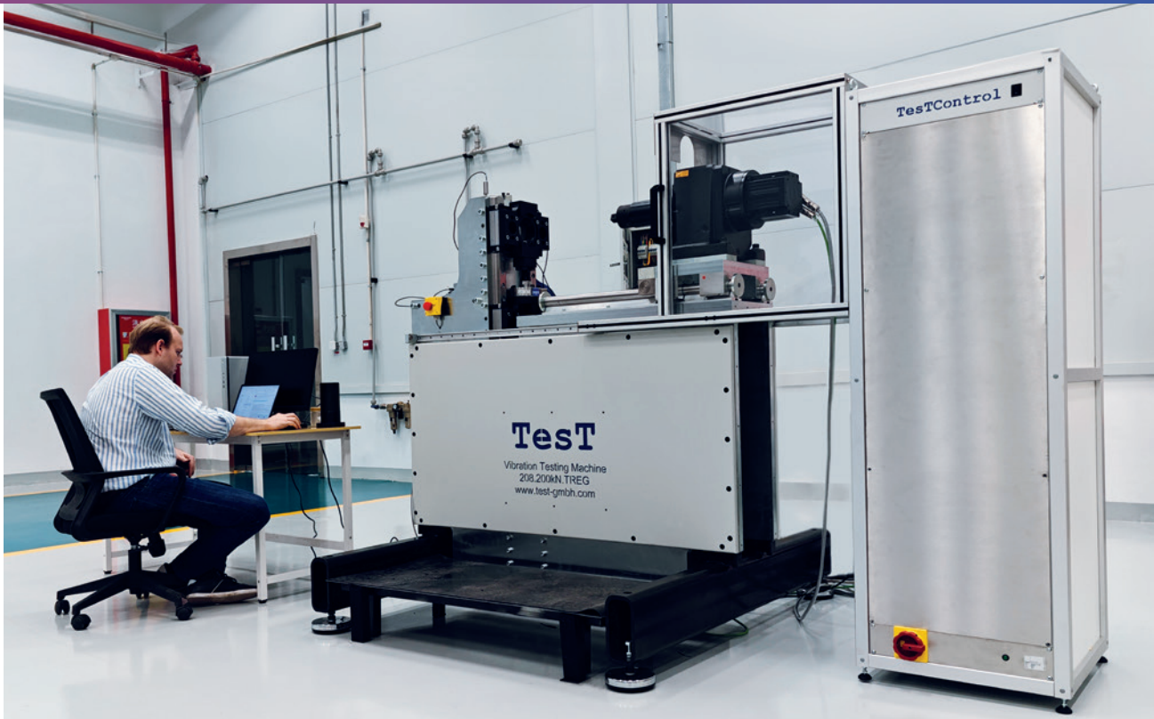
Kompletter Aufbau einer Test Vibrationsprüfmaschine
