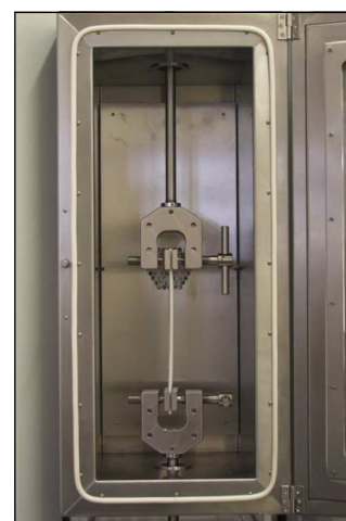
Temperierkammern und Öfen für die Material- und Bauteilprüfung unter Temperatureinfluss
