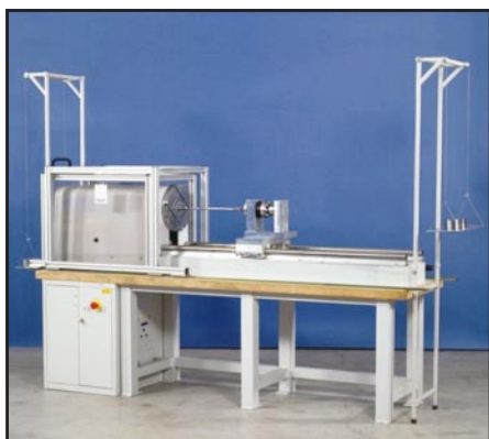
Modell 210S.500Nm mit Vorrichtung für axiale Belastung
